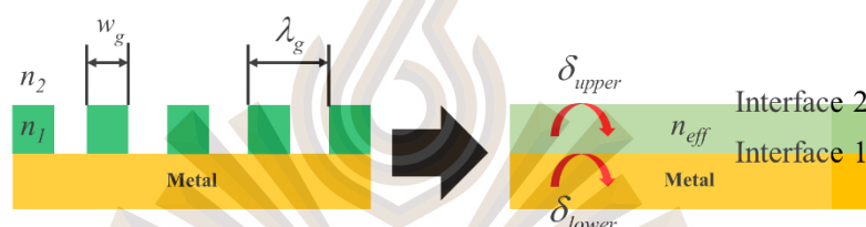
รูปที่ 3.7 แบบจำลองการเปลี่ยนโครงสร้างเกรตติงเป็นโครงสร้างผิวเรียบ
