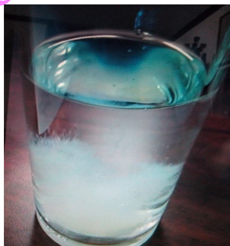
รูปที่ 15 วัดการละลายตัวของเม็ดยาที่มีขนาดใหญ่
