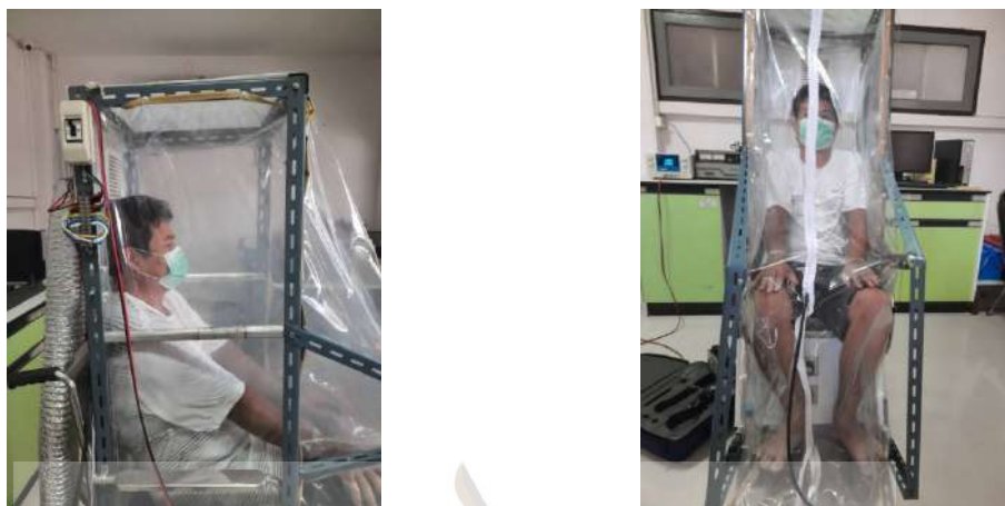
รูปที่ 4.7 แสดงการทดสอบด้วยชุดสร้างควัน (Smoke Generator)
