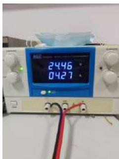
แหล่งจ่ายไฟฟ้ากระแสตรง
