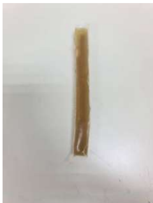
รูปที่ 3.9 ชิ้นงาน MCL-PHA ที่ได้จากแม่พิมพ์แบบสี่เหลี่ยมผืนผ้า
