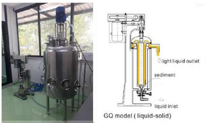
รูปที่ 3.1 ถังหมักชีวภาพขนาด 300 L และเครื่องปั่นเหวี่ยงทรงกระบอกแบบต่อเนื่อง
