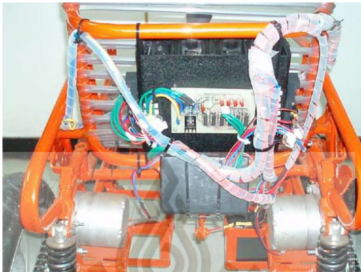
รูป ก-5 แสดงส่วนของการติดตั้งชุดควบคุมของตัวรถ
