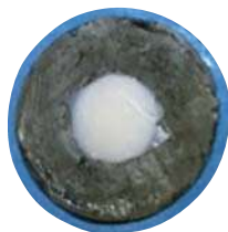
รูปที่ 2 ชิ้นงานบิสแอสคริลเรซินในอีพอกซีเรซินใส
