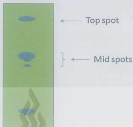
ภาพที่ 26 แสดงตำแหน่งของ Top spot และ Mid spots บนแผ่น Thin-Layer Chromatography
