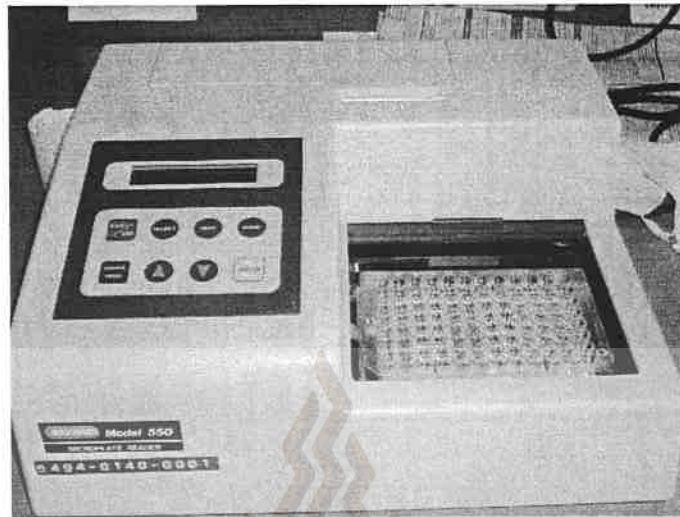
แสดงขั้นตอนการวัดโดยเครื่อง ELISA reader
