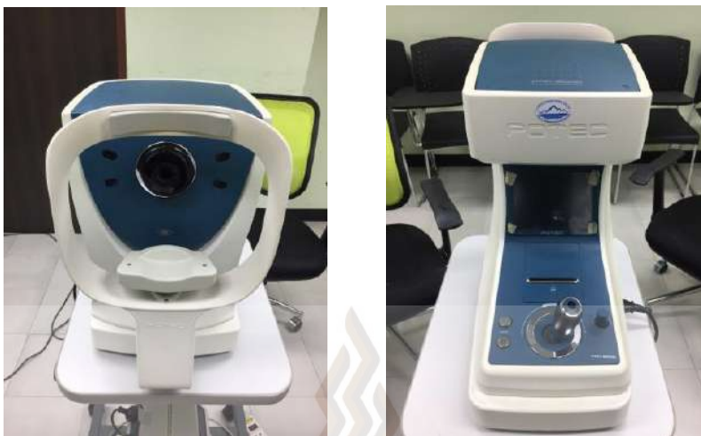
รูปที่ 3.4 เครื่องวัดสายตาอัตโนมัติ หรือ autorefractometer (model PRK 5000; Potec, Korea)
