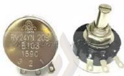
รูปที่ 3.6 ตัวถอดรหัสที่ใช้ในการประมาณค่ามุมของหุ่นยนต์
