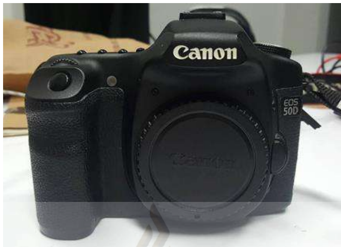
รูปที่ 58 กล้อง DHLR ที่ใช้เป็นส่วนบันทึกภาพของระบบกล้องจุลทรรศน์
