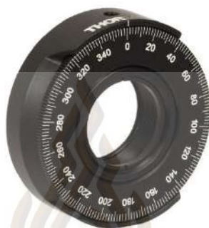
รูป 11 แสดงภาพตัวจับแผ่นโพลาริเซอร์ แผ่นครึ่งลูกคลื่น และ แผ่นโพลาริเซอร์วงกลม [27]
