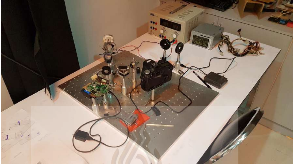
ภาพแสดงระบบต้นแบบกล้องจุลทรรศน์โฟโตลิโทกราฟีแบบไม่ใช้มาสก์
