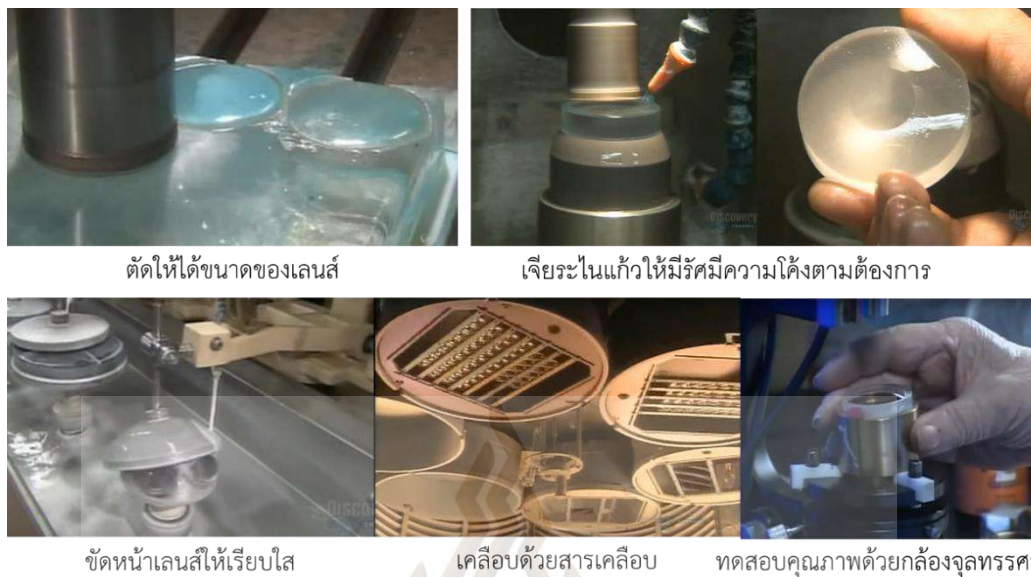
รูปที่ 8 แสดงขั้นตอนการทำเลนส์โดยวิธีการใช้เครื่องฝนและเจียรระโนตามวิธีมาตรฐาน
