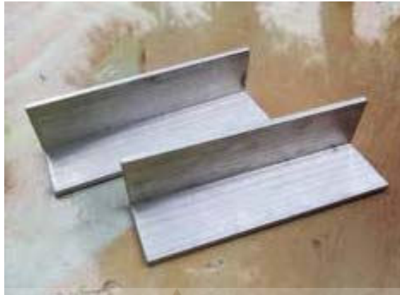
รูปที่ 3.2 แผ่นอลูมิเนียมฉาก ขนาดความหนา 1.5 mm.
