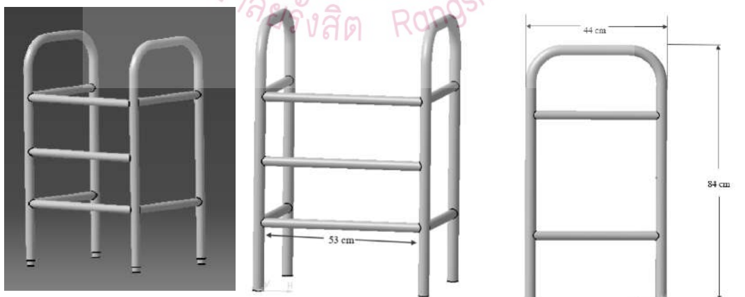
รูปที่ 3.2 แสดงการเลือกใช้ Walker ขนาดมาตรฐาน
