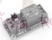
รูปที่ 3.41 แสดง Relay Module 1 Channel Isolation High and Low Trigger 5V
