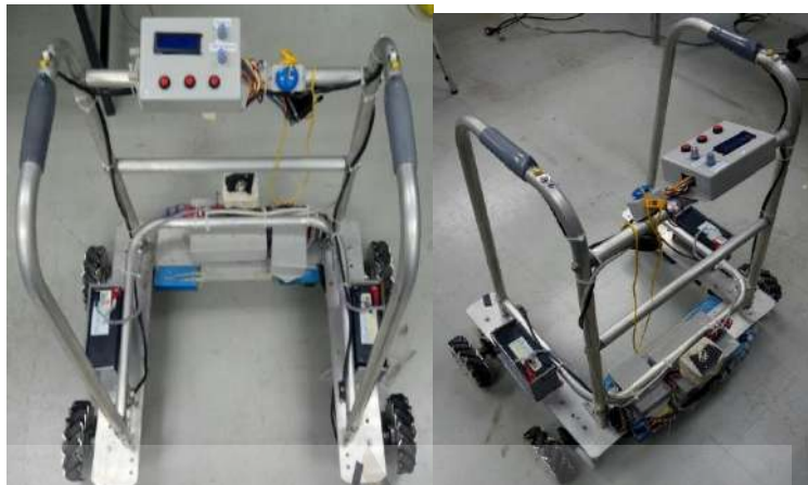
รูปที่ 3.7 แสดงเครื่องช่วยเดินสำหรับผู้พิการที่สามารถเคลื่อนที่ได้โดยอิสระโดยใช้ล้อแม่เหล็กถาวร
