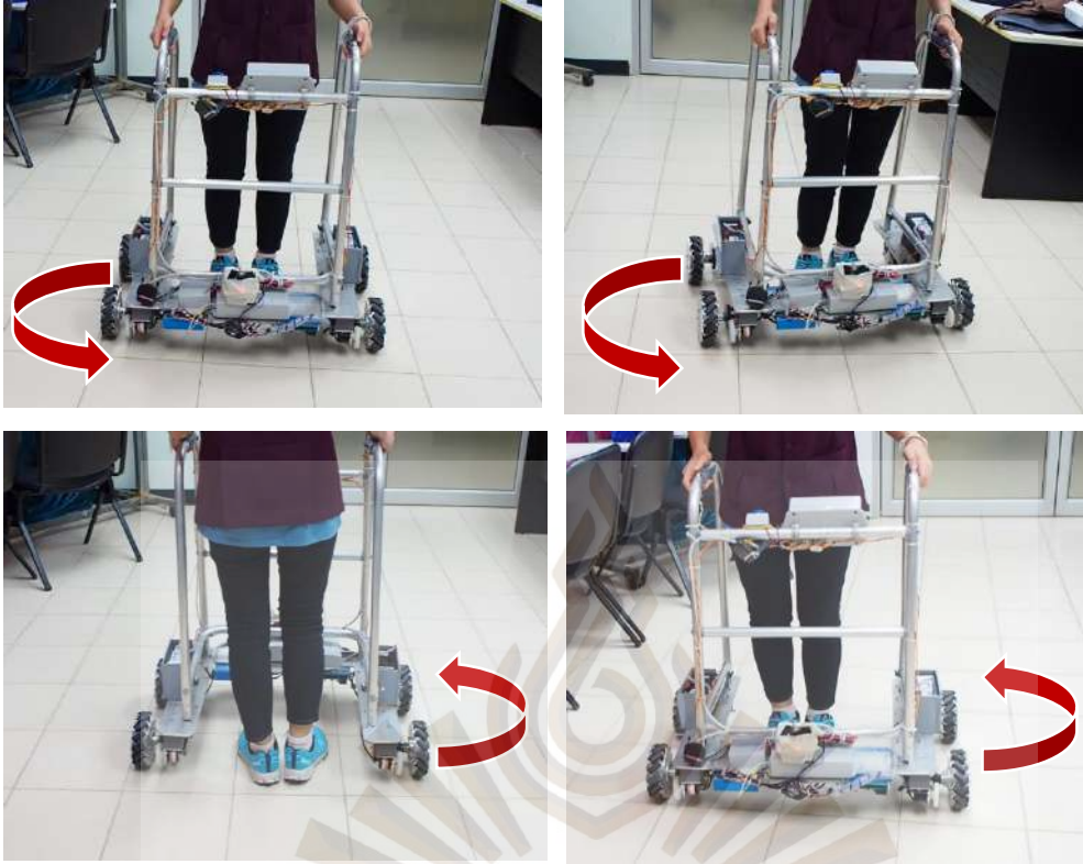
รูปที่ 4.25 แสดงการทดสอบการเคลื่อนที่หมุนซ้าย
