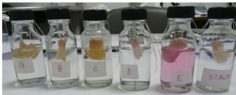
รูปที่ 2: แสดงตัวอย่างผลการทดลองละลายเนื้อเยื่อ จากสูตร A (MU lot 1)
