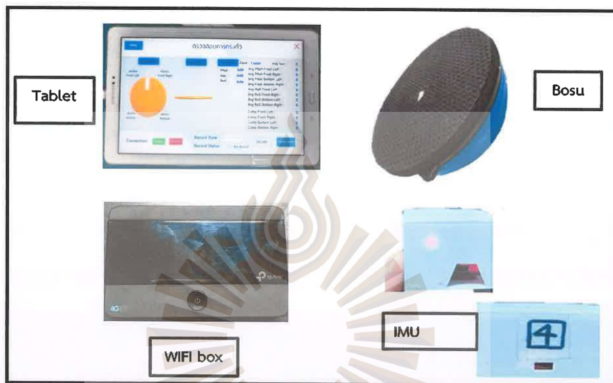
รูปที่ 3.2 อุปกรณ์ภายในชุดโปรแกรมการทดสอบการทรงตัว KR Balance kit
