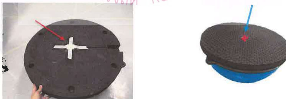
รูปที่ 3.3 จุดฝัง sensor และจุดอ้างอิงบนแผ่นยาง
