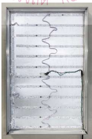
ภาพที่ 77 ภาพแสดงการวางตำแหน่งของไฟ LED rigid bar เมื่อติดตั้งภายในกล่องไฟ
