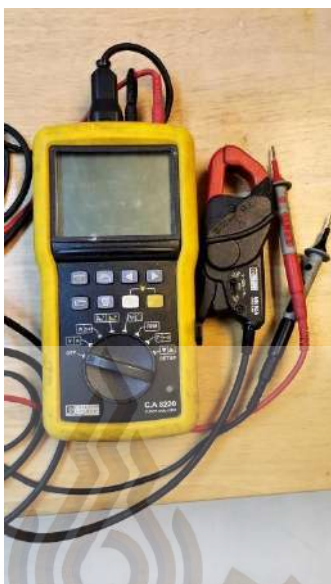
รูปที่ 3.7 มิเตอร์วัดค่ากระแสไฟฟ้า ยี่ห้อ Energy Meter รุ่น CA-8220
