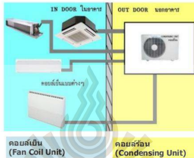
รูปที่ 2.19 เครื่องปรับอากาศแบบแยกส่วนระบายความร้อนด้วยอากาศ
