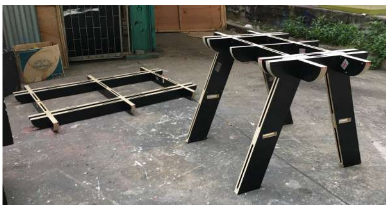
ภาพที่ 5.9 ตัดประกอบ โครงสร้างไม้อัดเคลือบฟิล์มดำ
