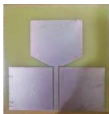
รูปที่ 4.1 สายอากาศโมโนโพลความถี่กว้างบนแผ่นวงจรพิมพ์ที่ป้อนโดยท่อนำคลื่นระนาบร่วมต้นแบบ
