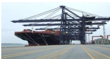
รูปที่ 2.12 Built in Crane ที่มา : Nation TV, 2019
