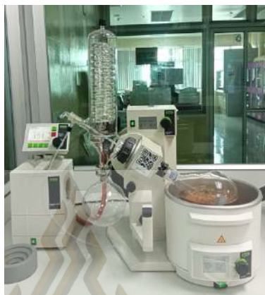
รูปที่ 3.5 ระเหยตัวทำละลายออกด้วยเครื่อง Rotary Evaporator
