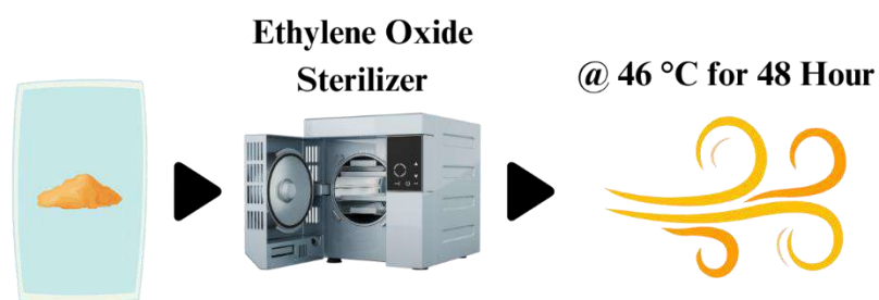
รูปที่ 3.8 แสดงกระบวนการทำให้ CH ปราศจากเชื้อด้วยเอทิลีนออกไซด์
