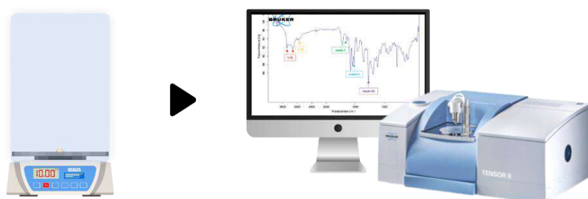
รูปที่ 3.3 แสดงกระบวนการตรวจสอบองค์ประกอบทางเคมีของ DMA ด้วยเทคนิค FTIR
