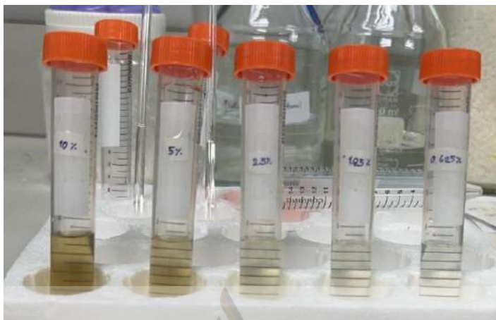
รูปที่ 4.5 แสดงเรซิน PEGDMA ที่มีความเข้มข้นของ ODMA ที่ 10% 5% 2.5% 1.25% และ 0.625 % (w/v) ตามลำดับ
