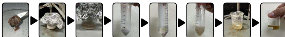
รูปที่ 3.5 แสดงกระบวนการเปลี่ยน DMA เป็น ODMA
