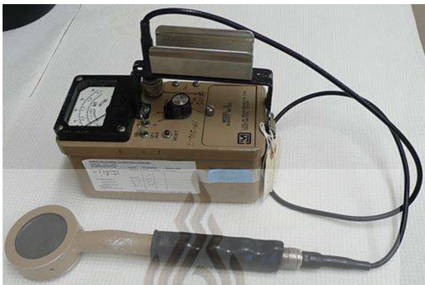
ภาพที่ 5 เครื่องตรวจวัดปริมาณรังสีไกเกอร์ (Geiger Muller counter) ชนิดหัววัดแบบแก๊ส (Gas detector)
