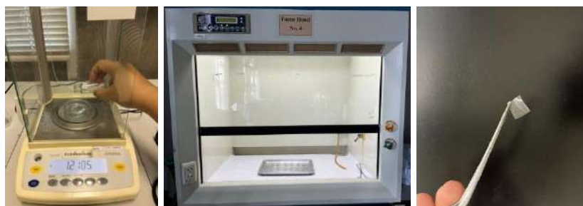
ภาพที่ 15 วิธีการชั่งสารตัวอย่าง (a) วิธีทำสารตัวอย่างให้แห้ง (b) และแผ่นฟิล์มขนาด 1 \times 1 \text{ cm} (c)
