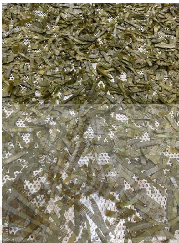
ภาพที่ 3.4 การอบใบไผ่ในตู้อบลมร้อน
