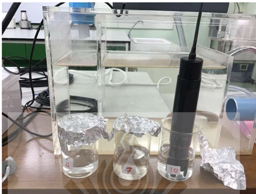
รูปที่ 3.2.2-2 การทดลองสร้างสมการคำนวณค่าความเป็นกรดและด่าง
