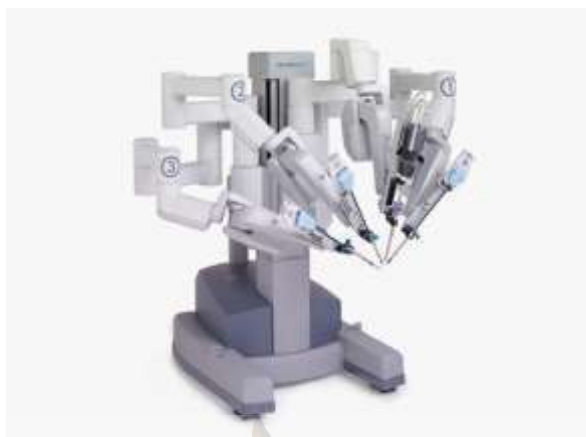
รูปที่ 2.1 หุ่นยนต์ช่วยผ่าตัด da Vinci ที่มา: Da Vinci robotic prostatectomy, 2019
