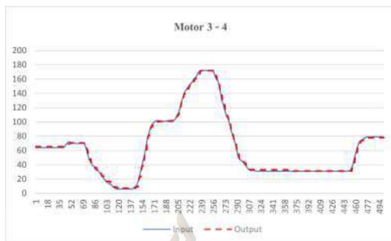
รูปที่ 4.18 กราฟควบคุมมอเตอร์ 3 - 4 ในเวลาจริง
