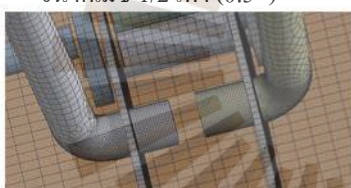
รูปที่ 3.32 รูปการทดสอบการลู่เข้าของอีลิเมนต์
