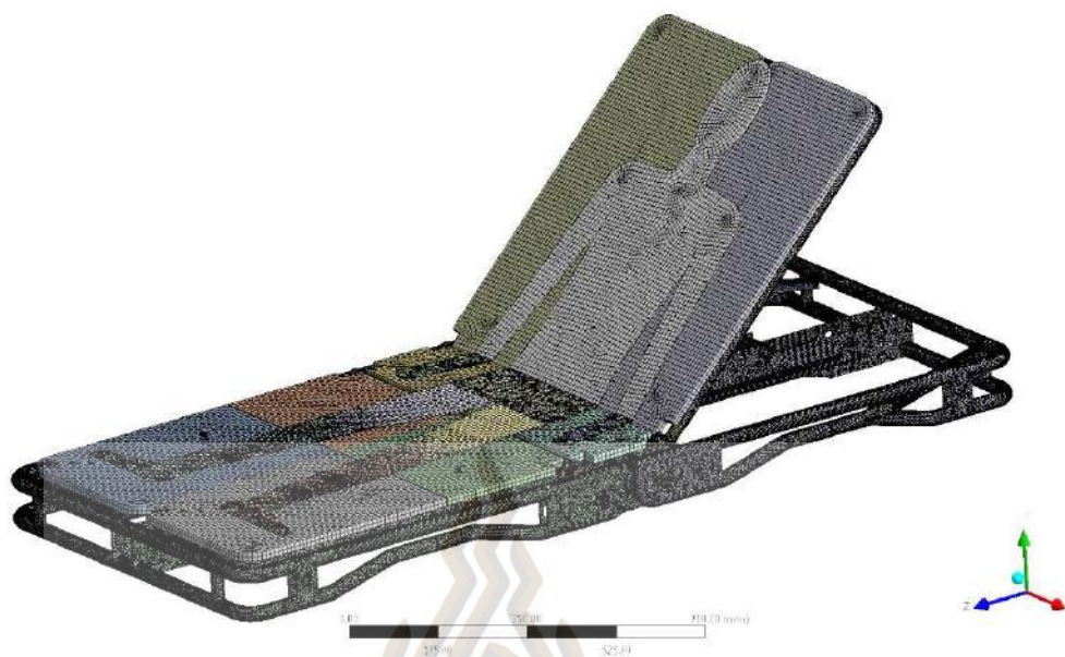
รูปที่ 3.28 แบบ FE Model โครงสร้างเตียงชั้นที่ 2 รูปแบบทำยกกล้าตัว 45 องศา
