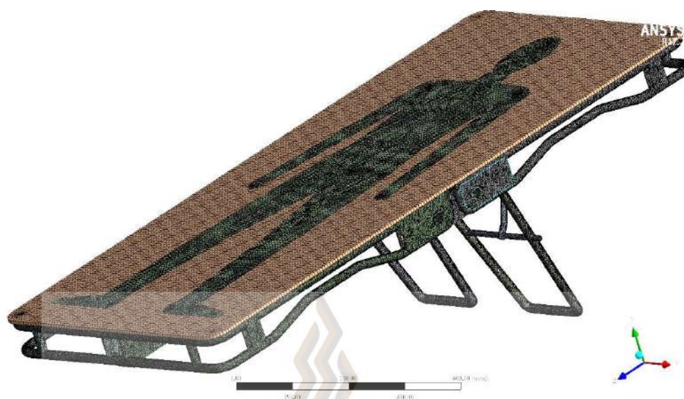
รูปที่ 3.26 แบบ FE Model โครงสร้างเตียงชั้นที่ 1 รูปแบบท่ายกหัวเตียงสูง 20 องศา
