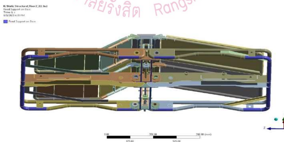
รูปที่ 3.38 การกำหนดจุดรองรับของโครงสร้างเตียงชั้นที่ 2 รูปแบบท่ายกสะโพก 200 มม.
