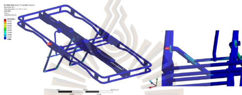
รูปที่ 4.26 ค่า Max. Von Mises Stress ของโครงสร้างชั้นที่ 1 ขนาด \varnothing 25.40 มม. ทำยกท้ายเตียง 20 องศา หลังการจำลองการรับภาระกรรม (ซ้าย) และ รายละเอียดตำแหน่งที่เกิด (ขวา)
