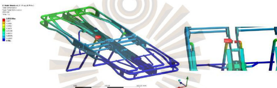
รูปที่ 4.29 ค่า Max. Deformation ของโครงสร้างชั้นที่ 1 ขนาด \varnothing 19 มม. ท่ายกท้ายเตียง 20 องศา หลังการจำลองการรับภาระกรรม (ซ้าย) และ รายละเอียดตำแหน่งที่เกิด (ขวา)
