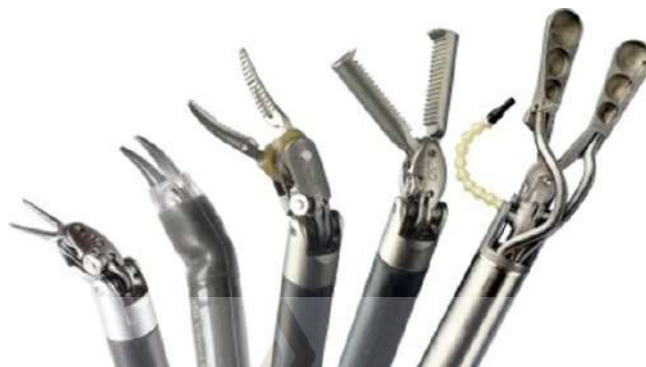
รูปที่ 2.11 กลุ่มอุปกรณ์ส่วนปลาย Da Vinci Surgical System
