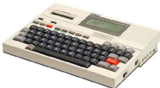
และต่อมาเกิด Epson HX-20 ใช้จอแบบ LCD มีแบตเตอรี่แบบชาร์ตได้ น้ำหนักแค่ 1.6 กิโลกรัม
