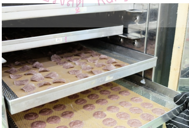
ภาพผนวกที่ ข6 ขั้นตอนการอบแห้งผลิตภัณฑ์โดยใช้เครื่องทำแห้งแบบถาด
