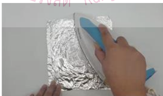
รูปที่ 3.14 ประกบด้วยแผ่นฝอยแล้วรีด
