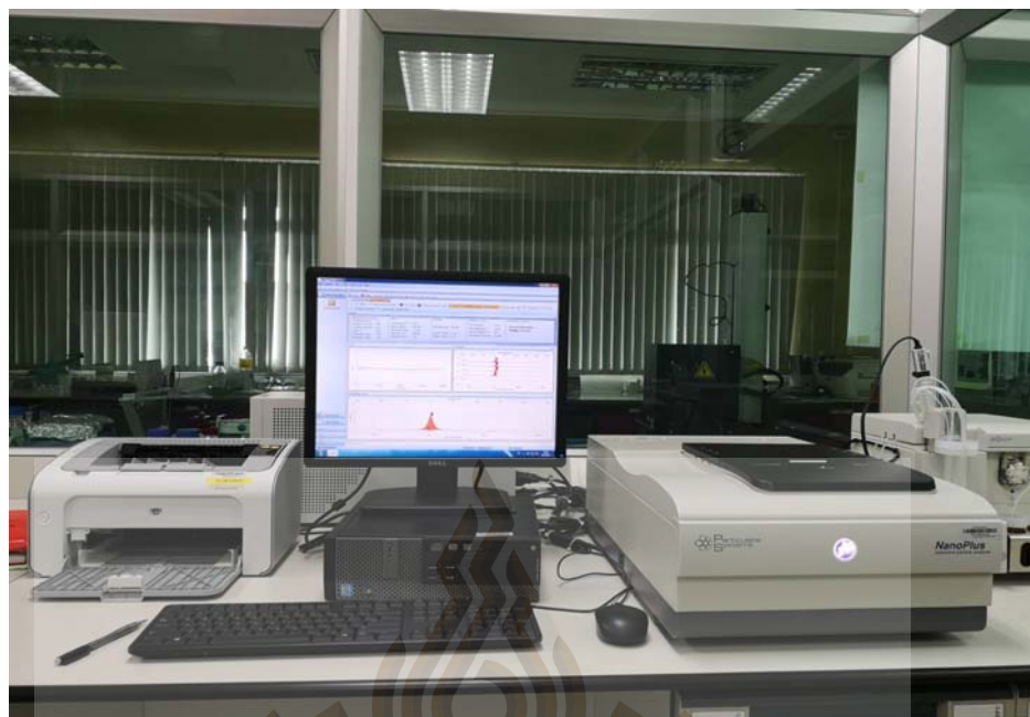
รูปที่ 5 เครื่องวัดขนาด และวัดค่าความต่างศักย์ไฟฟ้าซีต้า
