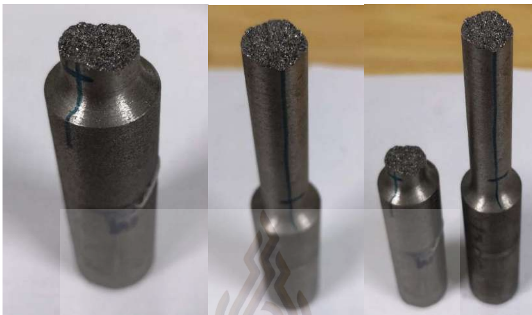
รูปที่ 4.5 ชิ้นงานทดสอบเหล็ก FC250 ภายหลังจากการดึงด้วยเครื่อง Universal Testing Machine
