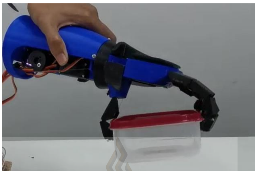
รูปที่ 4.10 การทดสอบควบคุมแขนกลหยิบจับวัตถุทรงลูกบาศก์ ขนาดกว้าง 10 เซนติเมตร สูง 5 เซนติเมตร
