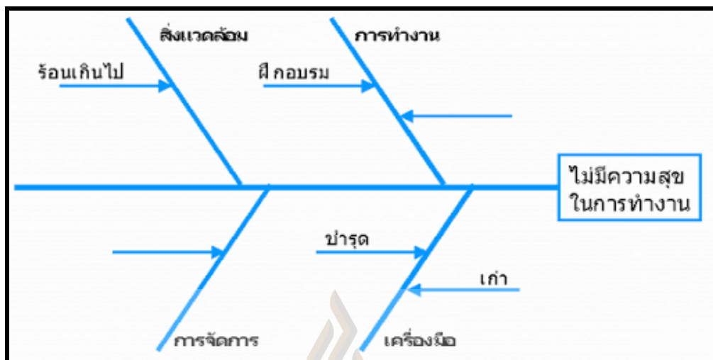
รูปที่ 2.3 ตัวอย่างผังแสดงเหตุและผล (Cause and Effect Diagram)
