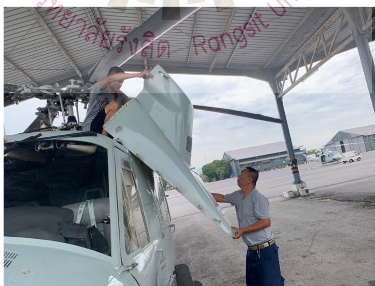
รูปที่ 4.8 ทำการถอด Cover Transmission
