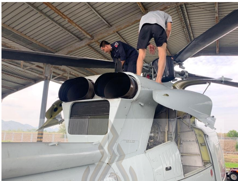
รูปที่ 4.14 การทำความสะอาด Cabin Roof
