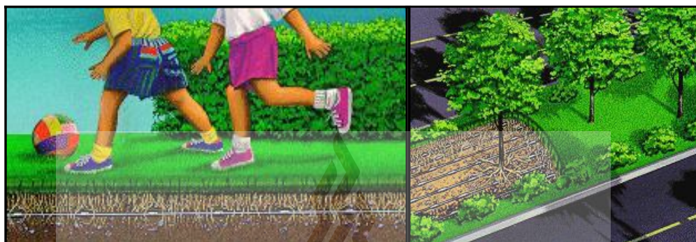
รูปที่ 2.5 แสดงรูปแบบการชลประทานแบบฝังใต้ดินของประเทศอิสราเอล ที่มา : กระทรวงทรัพยากรธรรมชาติและสิ่งแวดล้อม, 2558
