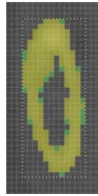
รูปที่ 4.21 การเปรียบเทียบส่วนต่างระหว่างรูปที่ 4.20A ภาพต้นฉบับ กับรูปที่ 4.20B ค่า Threshold ให้อยู่ในช่วง 130 ถึง 1,500
