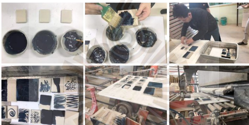
รูปที่ 4.6 การทดลองย้อมกระเบื้องด้วยการจุ่มและพื้นที่ลงไปและเผาอุณหภูมิ 1,300 องศาเซลเซียส
