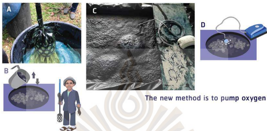
รูปที่ 5.8 การใช้เครื่องปั๊มออกซิเจนทำให้ผ่อนแรงในการใช้มือและเครื่องกวาด
