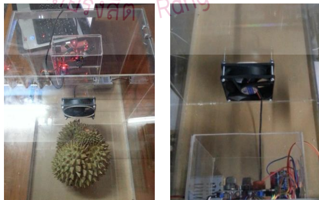
รูปที่ 4.1 แสดงอุปกรณ์วัดระดับการสุกของทุเรียน
