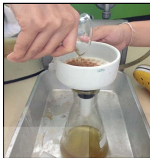
รูปที่ 3 แสดงขั้นตอนการนำสารสกัดโกฐเชียงที่ได้ไปกรองด้วยเครื่องกรอง Burner โดยผ่านกระดาษกรอง Whatman เบอร์ 1
