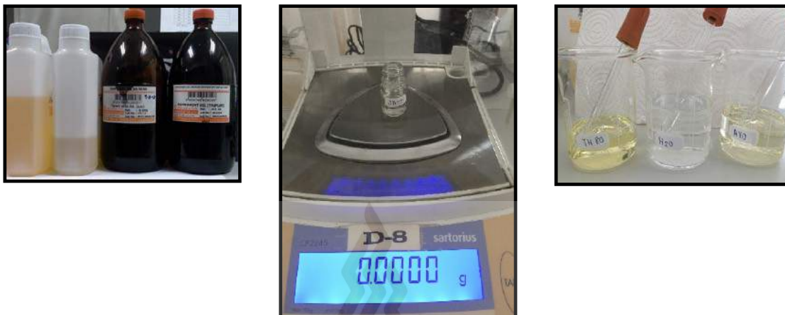
รูปที่ 7 แสดงถึงขั้นตอนการเตรียมสูตรตำรับพื้นฐาน ประกอบด้วย สารลดแรงตึงผิว (Tween20, Tween80, Span80) น้ำมันหอมระเหย (น้ำมันอโวคาโดและน้ำมันโรสแมรี่) และน้ำ
